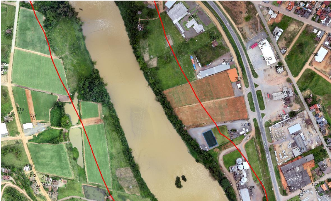
Figura 30 - Trecho do Rio Itajaí Açú com 140 metros de largura e faixa de APP de 100 metros
