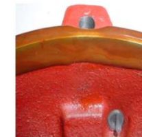
Vedação nas Juntas
