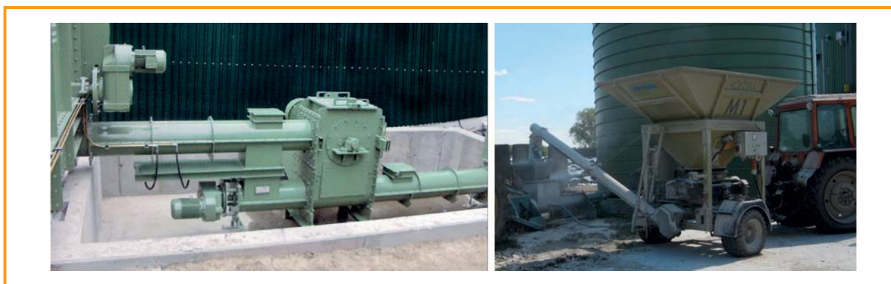
Figura 3.7: moinho de martelo e de rolo para fragmentação de substratos sólidos [Huning Maschinenbau GmbH, DBFZ]
