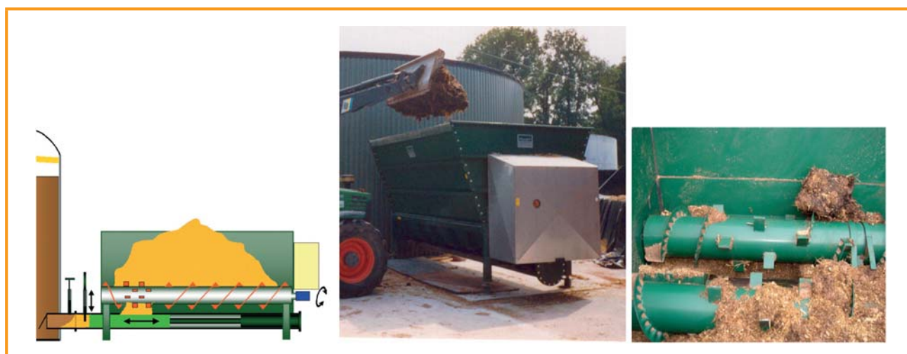
Figura 3.18: Carregamento de biomassa empilhável com pistão de alimentação [PlanET Biogastechnik GmbH]
