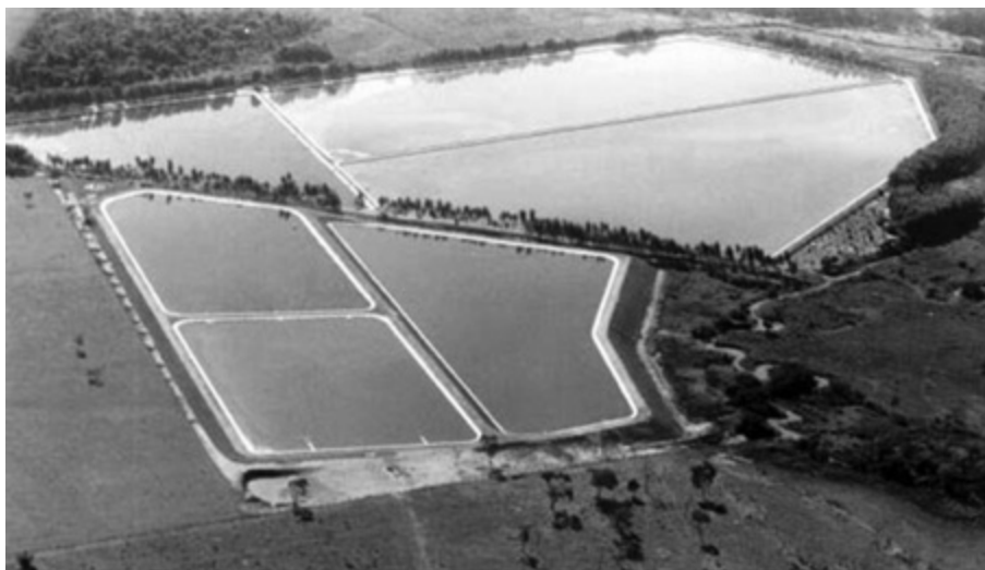
ILUSTRAÇÃO 3.5.3.1 – SISTEMA DE LAGOAS BEM OPERADO
